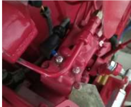
Figura 12 Solenoide sin paso de combustible y energizado.
