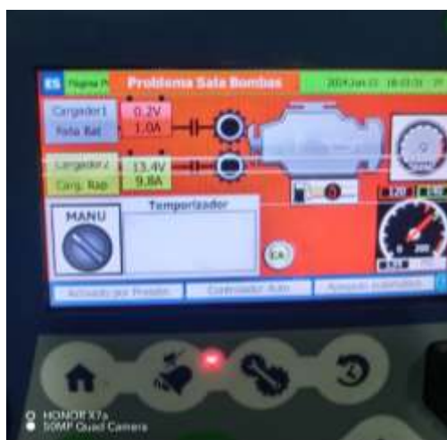
Figura 5. Falla en cargador número 1.
