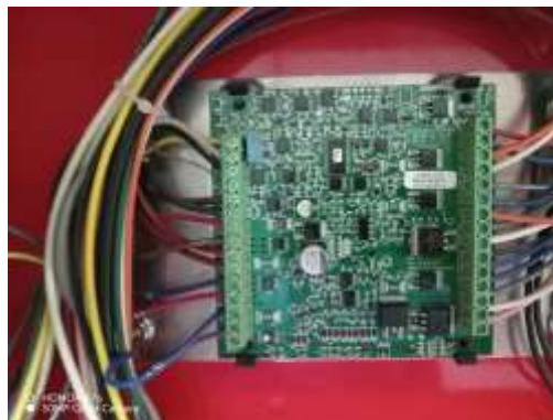
Figura 9. Tarjeta Makeup de motor diésel sin voltaje de salida al solenoide.
