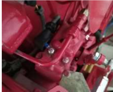
Figura 10. Solenoide de inyección de motor diésel.
