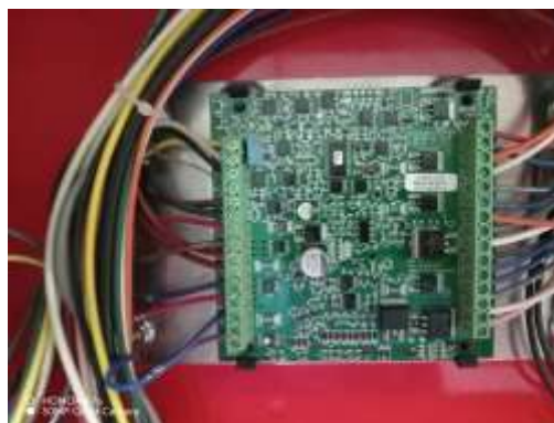
Figura 9. Tarjeta Makeup de motor diésel sin voltaje de salida al solenoide.
