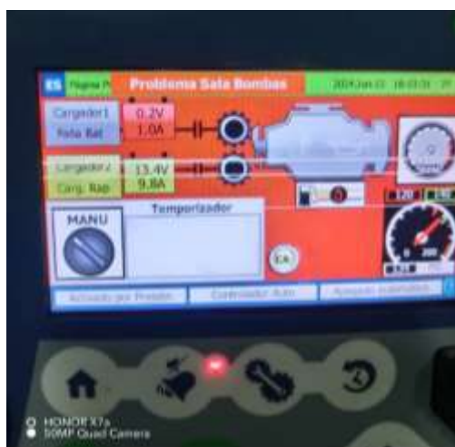
Figura 5. Falla en cargador número 1.
